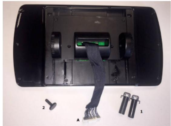
Una vez conectado el cableado, debe introducir la pantalla entre los brazos de sujeción y fijar la pantalla mediante los topes de fijación suministrados (figura 1)
