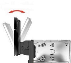
Una vez seleccionada la posición de altura, regule la inclinación deseada del display aflojando la rueda de la figura 2. y posicione la pantalla manualmente hasta seleccionar el ángulo deseado, una vez bien posicionada, gire la rueda de nuevo hasta que quede fuertemente fijada
